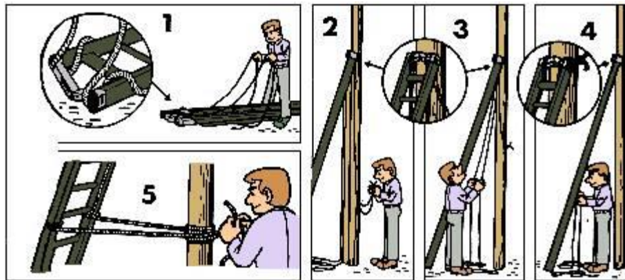
Figura 3. Inmovilización de la parte superior de una escalera
