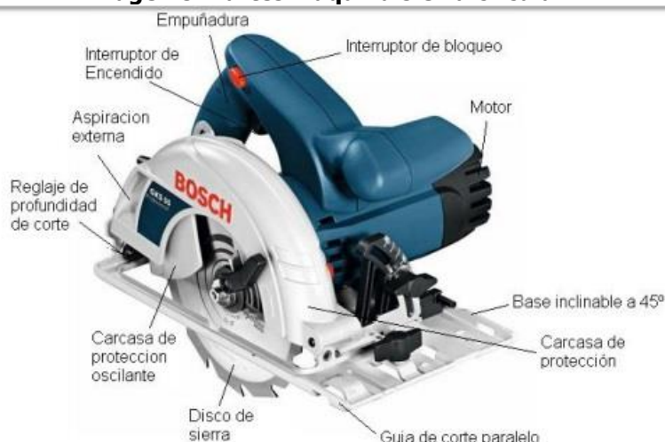
Imagen 8. Partes Máquina sierra circular
