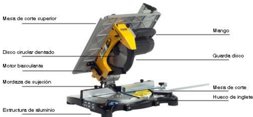
Imagen 6. Partes Maquina Ingleteadora
